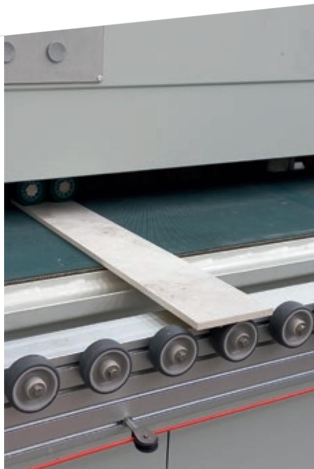
Ruedas dúplex de los prensos con longitud mín del cabezal de 150 mm.
